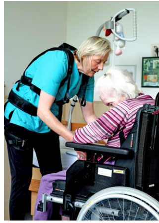
Eine Bewohnerin wird mithilfe des Liftsuits sicher angehoben – das Exoskelett entlastet dabei die Pflegekraft spürbar im Rücken- und Hüftbereich.
